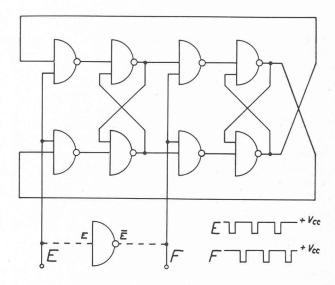
Fig. 2. — Diviseur de fréquence en anneau : schéma logique.
