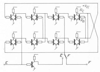
Fig. 3. — Diviseur de fréquence en anneau : schéma électrique.
