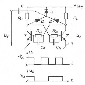
Fig. 1. — Multivibrateur bistable classique (flip-flop).
