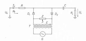
Fig. 1. — Schéma de principe de l'amplificateur.  $U_e = \text{tension continue d'entrée};$   $U_s = \text{tension alternative de sortie};$   $D_1, D_2 = \text{diodes à capacité variable};$  Z = impédance d'équilibrage du pont;= résistance de charge.
