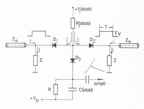
Fig. 2. — Schéma du convertisseur temps-amplitude.
