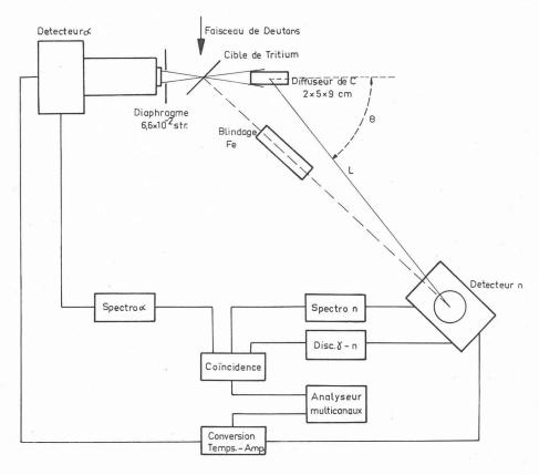
Fig. 1. — Schéma fonctionnel de l'expérience.
