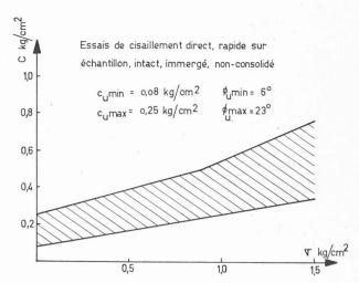
Fig. 5. — Fuseau des essais de cisaillement.
