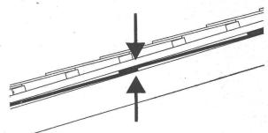
Le maître couvreur recommande la soustoiture ETERNIT, élément nécessaire du toit. Les plaques d'amiante-ciment ETERNIT et GEA en augmentent le pouvoir isolant. Elles forment une couverture étanche aux poussières, à la pluie, à la neige et à l'eau de fonte de celle-ci. Incombustibles, elles diminuent le danger d'incendie. La pose de la soustoiture ETERNIT est simple et rapide.
