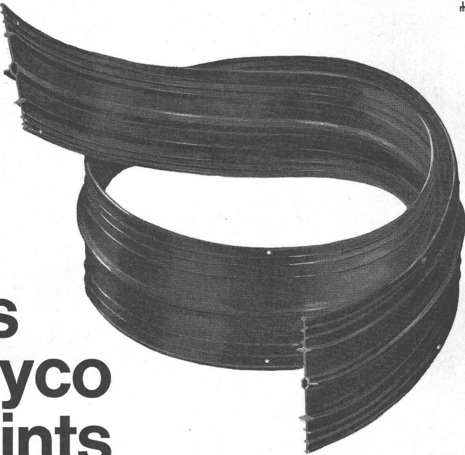
L'assortiment des rubans Meyco pour joints, éprouvés depuis des années, a de nouveau été élargi. De ce fait les rubans pour joints offrent maintenant une grande sécurité d'étanchement pour tous les genres de constructions (série A pour joints de travail, série D pour joints de dilatation). Les rubans Meyco pour joints ne présentent ni arêtes vives ni angles saillants. La conception bien
