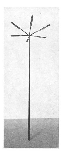
Fig. 37 (à gauche). — Places devant les entrées principales: mât métallique à six bras supportant chacun trois tubes fluorescents (trois tubes de 65 W ou trois tubes de 125 W); flux lumineux: 8000 ou 13 500 Lumens; hauteur du mât: 15 m; éclairement: 50 ou 80 Lux au pied du mât et 25 ou 40 Lux à 15 m.
