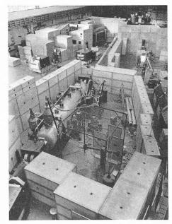
Fig. 4. — Séparateur électrostatique de 10 m du CERN, installé sur la trajectoire d'un faisceau.
