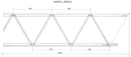
Fig. 29. — Elément type de l'ossature du secteur C 4.
