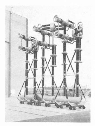
Fig. 3. — Vue du transformateur à 750 kV prise dans les ateliers de la S.A. Brown, Boveri &  $C^{1e}$ .
