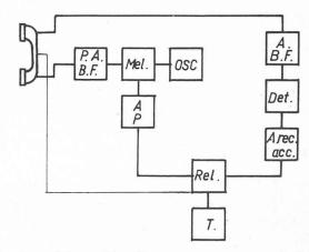
Fig. 2. — Schéma bloc d'un émetteur-récepteur hydrotéléphonique à transistors.
