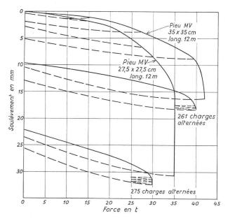
Fig. 10. — Résultat d'essai de pieux en traction.
