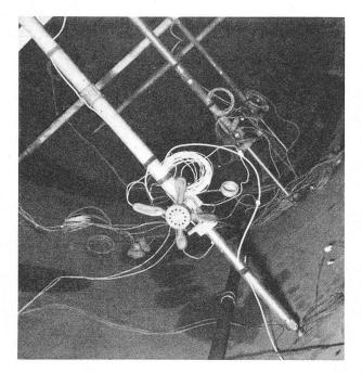
Fig. 4. - Extensomètres télescopiques.
