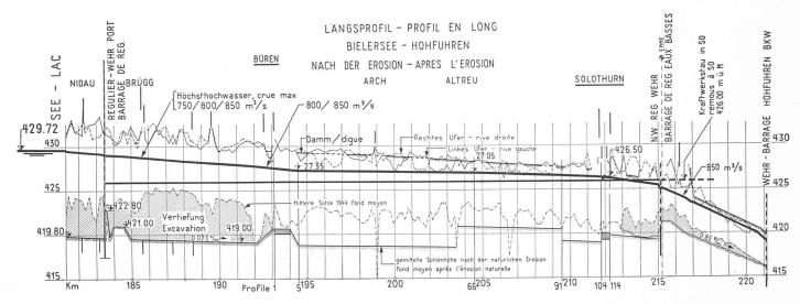
Fig. 9. — Profils en long du niveau moyen du radier et des niveaux maximums de l'Aar entre le lac de Bienne et le barrage de Hohfuhren, après la deuxième correction.
