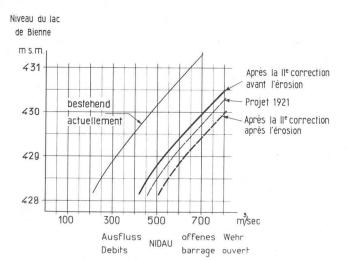
Fig. 8. — Capacité du canal de Nidau à Büren.
