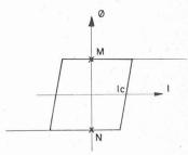
Cycle d'hystérésis rectangulaire d'un tore magnétique.
