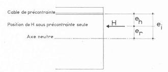
Fig. 2. — Effet de la précontrainte seule dans une section de poutre d'un système hyperstatique.
