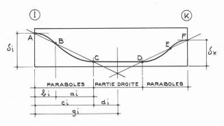
Fig. 7. — Tracé-type avec partie droite.
