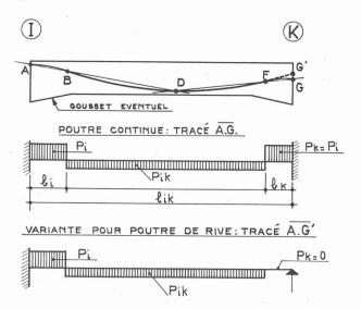
Fig. 5. — Tracé-type: charges fictives équivalentes.
