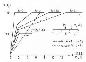
Fig. 22. — Diagramme des flèches en fonction des charges pour une poutre continue sur quatre appuis.
