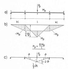
Fig. 14. Mécanisme et charge de rupture d'une poutre sur quatre appuis, avec charge concentrée.
