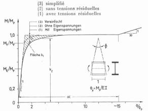
Fig. 8. — Relation entre le moment fléchissant et la courbure. (Section I — représentation en valeurs relatives.)
