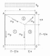
Fig. 16. Mécanisme d'une dalle uniformément chargée.
