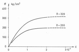
Fig. 6. — Diagramme d'allongement pour le béton.
