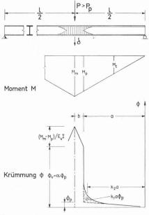
Variation de la courbure dans le cas d'une poutre simple avec une charge concentrée.
