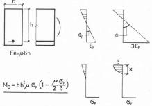
Moment plastique pour une section en béton armé.
