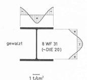
Fig. 4. Diagramme des tensions résiduelles d'une poutrelle laminée et d'un pilier composé soudé.
