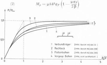
Fig. 10. — Relation entre la charge et les flèches de différentes poutres (représentation en valeurs relatives).
