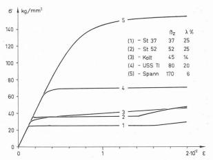
Fig. 5. — Diagrammes d'allongement de différents aciers.
