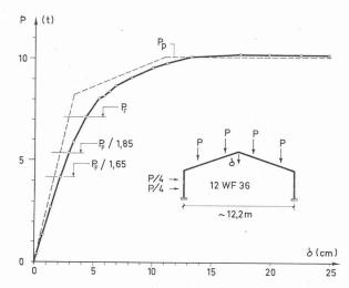
Fig. 47. — Diagramme de la flèche d'un cadre au cours d'un essai à la rupture.
