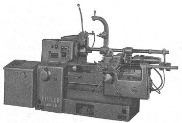
Passage de barre 25, 32, 40, 45, 50, 63, 80, 102 et 110 mm. Rendement de coupe élevé et faibles temps morts grâce à la sélection des vitesses à main ou automatiques agissant instantanément. Changement automatique des vitesses de la broche en fonction de la position de la tourelle revolver.
