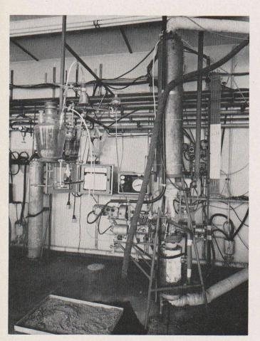
Fig. 2. — Modèle de laboratoire d'un réacteur tubulaire.
