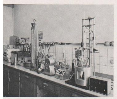
Fig. 4. — Instruments permettant la mesure des caractéristiques des corps. De gauche à droite : Mesure de pression de vapeur, mesure du point de fusion, appareil à sublimation avec mesures de pression, chambre à déterminer les isothermes de sorption.
