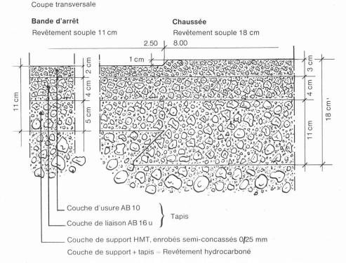
Fig. 3. — Coupe transversale de la chaussée et bande d'arrêt avec revêtements hydrocarbonés.
