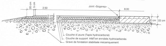
Fig. 1. — Coupe transversale de la bande d'arrêt avec revêtement hydrocarboné.
