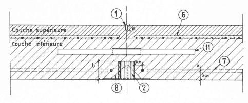
Fig. 1. — Joint longitudinal.
