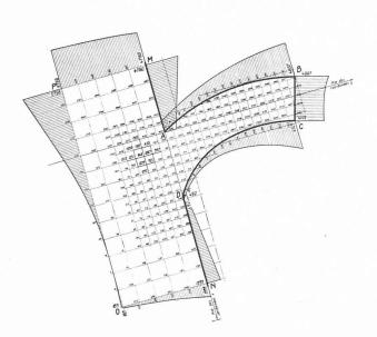
Fig. 10. — Valeurs de la fonction de contrainte —  $F.10^3$  sur le pourtour et à l'intérieur du domaine considéré.
