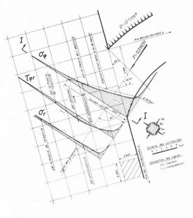
ment vers le sommet de l'angle. Si l'on désire que les contraintes restent inférieures à la limite d'élasticité de la matière, il est nécessaire d'arrondir les coins formés par les angles.
