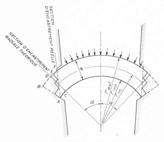
Fig. 1. — Coupe horizontale schématique d'un barrage-voûte — arc circulaire.
