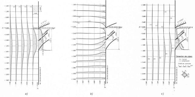
Fig. 13. — Contraintes dans le rocher en t/m².
