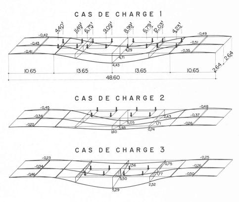
Fig. 7. — Flèches élastiques, en mm.
