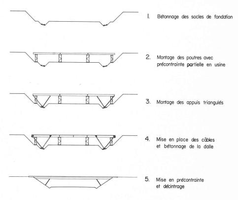
Fig. 4. - Schéma de montage.
