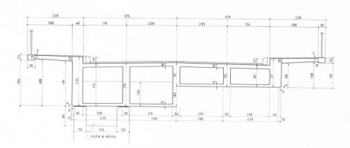
Fig. 6. — Coupe transversale sur appui et en travée.
