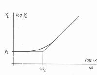
Fig. 6.4. — Admittance de charge  $Y_L$  en fonction de la pulsation  $\omega$ .
