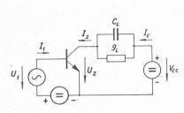
Fig. 6.1. Amplificateur chargé par une admittance  $\overline{Y}_L = g_L + j\omega C_L$ .
