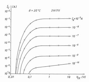
Fig. 2.4. — Courant de collecteur  $I_C$  en fonction de la tension collecteur-émetteur  $V_{CE}$  pour dissérents courants de base  $I_B$ .
