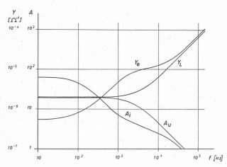
Fig. 6.5. — Détermination de l'amplification de courant  $A_i$  en fonction de la fréquence f du signal appliqué.
