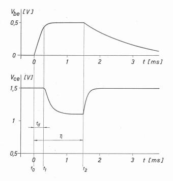
Fig. 7.2.1. — Mise en conduction et blocage du transistor commandé en courant en montage émetteur commun.
