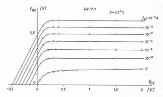
Fig. 2.5. — Tension base-émetteur  $V_{BE}$  en fonction de la tension collecteur-émetteur  $V_{CE}$  pour différents courants de base  $I_B$ .
