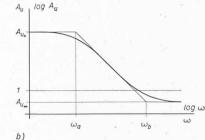
Fig. 6.2. — Amplification de tension  $A_u$  de l'amplificateur de la figure 6.1.
