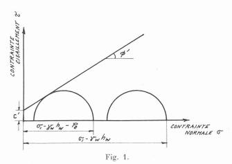
$\sigma_l=$  contrainte verticale apparente.  $h_w=$  hauteur de la nappe phréatique.  $\gamma_w=$  densité de l'eau -  $P^e=$  pression d'injection
