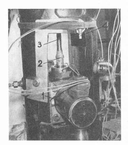
Fig. 1. — Compresseur à gaz de synthèse pour 3000 atmosphères.
