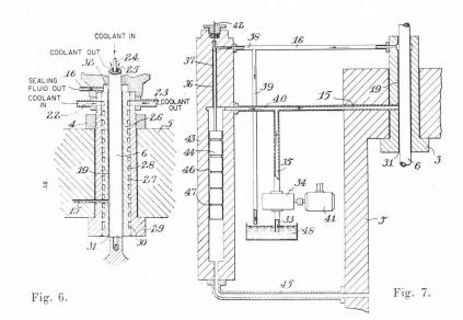
Fig. 6. — Principe de construction du joint à l'arbre.
