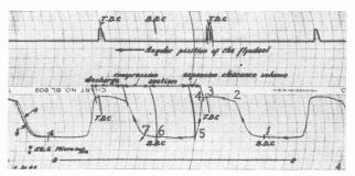
Fig. 3. — Diagramme indicateur (pression-volume) d'un compresseur à gaz de synthèse pour 3000 atmosphères.
