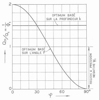
Fig. 10. — Coefficient de débit  $\Phi_{\bf l}$ , en fonction de l'angle de l'hélice  $\phi.$
