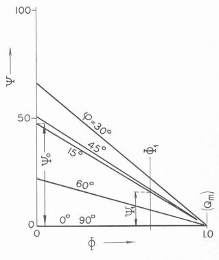
Fig. 13. — Caractéristiques pression-débit. (Optimum basé sur h.)
