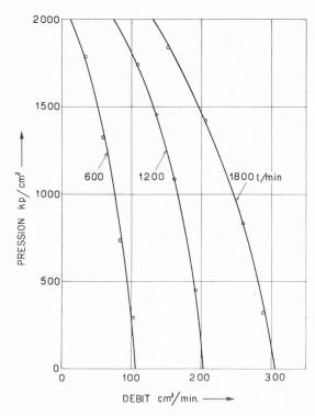
Fig. 9. — Caractéristiques débit-pression d'une pompe à viscosité.
