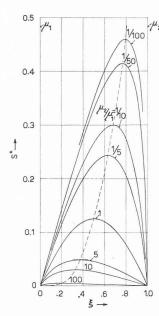
Fig. 18. — Ecoulement de pression. Distribution de la vitesse pour une répartition linéaire de la viscosité entre  $\mu_1$  et  $\mu_2$ .
