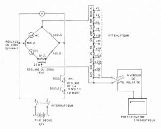
Fig. 3. — Schéma du montage électrique.
