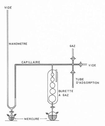
Fig. 1. — Eléments essentiels d'une installation volumétrique classique B.E.T.
