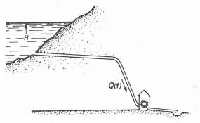
Fig. 1. — Schéma d'une installation hydro-électrique avec bassin d'accumulation.
