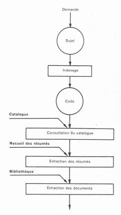
Fig. 10. — Schéma de la recherche de documents traitant d'un sujet donné.
