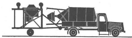
1. Position de transport. Silo à ciment sur le pont du camion avec balance montée. Support métallique avec bétonnière en remorque.
