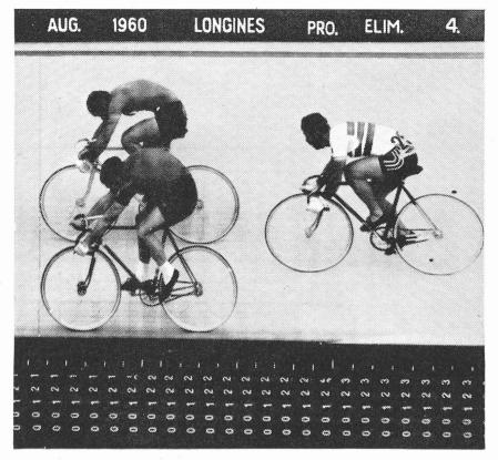
Fig. 10. — Film obtenu avec la caméra à fente. Temps au centième de seconde.
