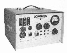
Fig. 5. — Horloge à quartz portative pour la commande d'appareils de chronométrage.
