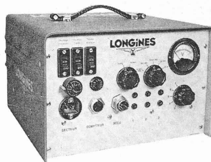
Fig. 5. — Horloge à quartz portable pour la commande d'appareils de chronométrage.
