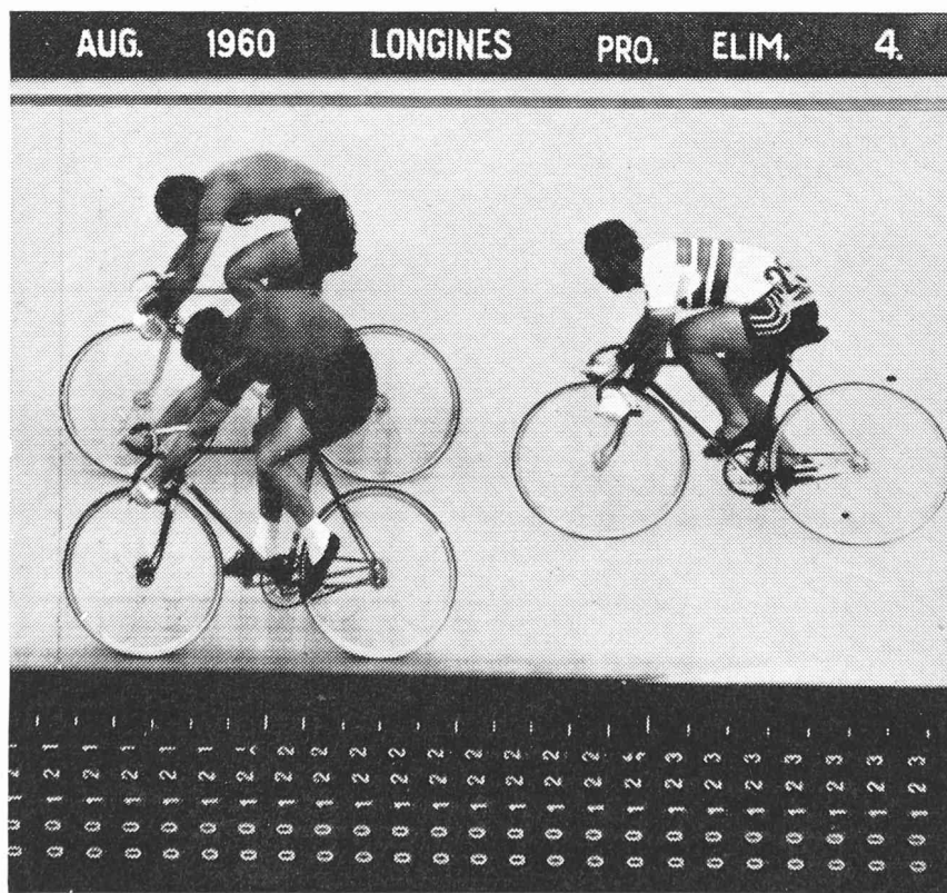
Fig. 10. — Film obtenu avec la caméra à fente. Temps au centième de seconde.
