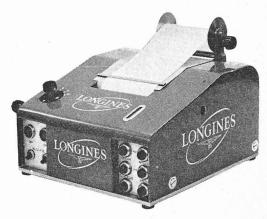
Fig. 4. — Appareil de chronométrage à bande enregistreuse.
