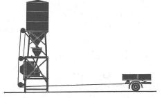
Position de transport. Silo à ciment sur le pont du camion avec balance montée. Support métallique avec bétonnière en remorque.
