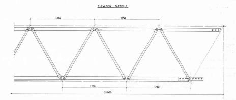
Fig. 7. — Elément type de l'ossature du secteur C4.
