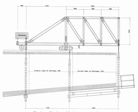
Fig. 4. — Chariot mobile du pont sur la Sorge.
