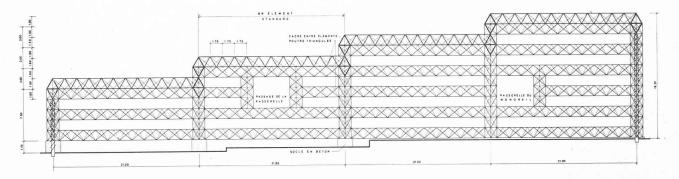
Fig. 9. — Coupe longitudinale de l'ossature du secteur C4.
