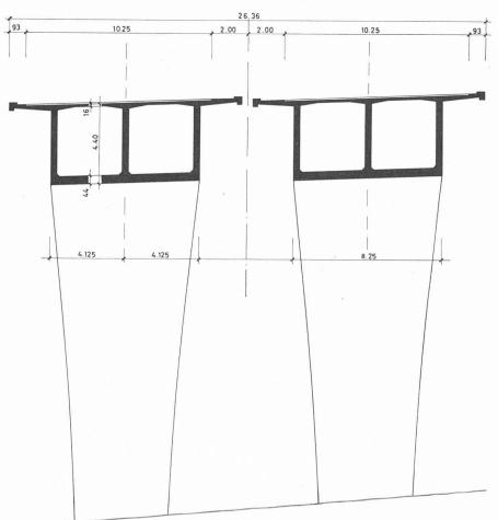
Fig. 3. — Coupes en travers du pont sur la Sorge.
