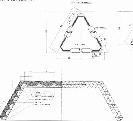
Fig. 8. — Coupe transversale de l'ossature du secteur C4.
