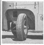
Grâce au braquage avantageux des roues directrices (85°), le MATBRO se laisse diriger n'importe où. Rayon de braquage inférieur à 2 m. Les deux modèles ci-dessus de 2 et 3 tonnes sont équipés d'un convertisseur de couple, servo-direction, freins à disques. Très maniables et rapides, ils résolvent les problèmes de manutention même sur des emplacements étroits.
