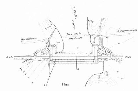
Fig. 10. — Le barrage de déviation sur le fleuve Nestos pour l'irrigation de la plaine de Chryssoupolis. Plan du barrage. — Coupe transversale du déversoir et du pont route situé au-dessus.
