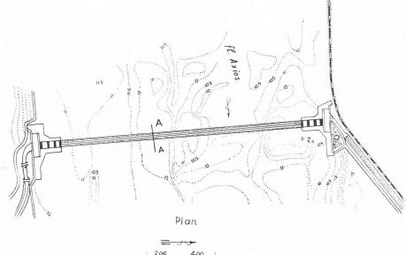
Fig. 8. — Le barrage de déviation sur le fleuve! Axios pour l'irrigation de la partie est de la plaine de Thessalonique. Plan du barrage. — Coupe transversale du déversoir.
