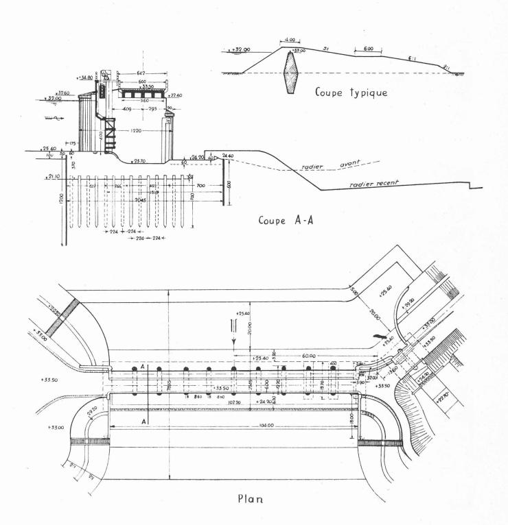
Fig. 2. — Le barrage de retenue du lac artificiel de Kerkini. Coupe longitudinale de la digue. — Coupe transversale de la digue. — Plan du barrage. — Coupe transversale du barrage.
