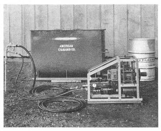
Fig. 3. — Equipement typique pour l'injection de l'AM-9.
