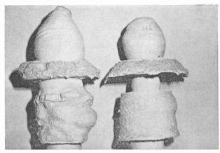
Fig. 9. — Influence du rapport du temps de la prise à la vitesse avec laquelle la lance à injection a été retirée sur la pénétration uniforme du coulis.
