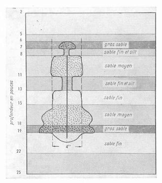
Fig. 7. — Coupe transversale typique d'un point d'injection.
