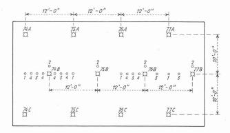
I forage d'injection au ciment o forage d'injection chimique Les chiffres donnent l'ordre dans lequel les forages et les injections ont été effectués
