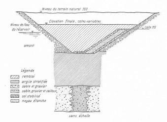
Fig. 13. — Coupe transversale du voile d'étanchéité.
