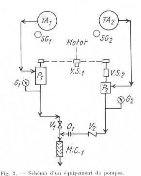
$TA_1 \qquad \qquad \text{bac à m\'elanger du coulis chimique AM-9 et du produit catalytique DMAPN} \\ TA_2 \qquad \qquad \text{bac à m\'elanger du persulfure d'ammonium indicateur à vue} \\ P_1 \text{ et } P_2 \qquad \qquad \text{pompes} \\ V.S_{-1} \text{ et } V.S_{-2} \\ G_1 \text{ et } G_2 \qquad \qquad \text{manom\`etres} \\ V_1 \text{ et } V_2 \qquad \qquad \text{soupapes} \\ O \qquad \qquad \text{orifice} \\ \end{cases}$
