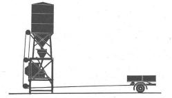
Position de transport. Silo à ciment sur le pont du camion avec balance montée. Support métallique avec bétonnière en remorque.
