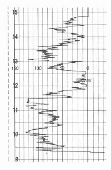
Fig. 3. — Exemple de courbe de charge d'une centrale asservie à un réglage fréquence-puissance.
