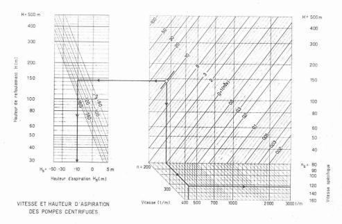
Fig. 7. — Abaque pour la détermination de la vitesse spécifique et de la hauteur d'aspiration des pompes.
