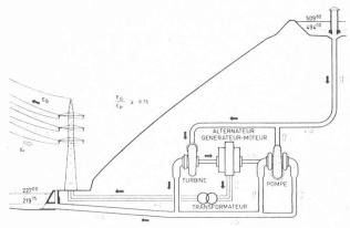
Fig. 1. — Principe de fonctionnement de l'aménagement L'énergie disponible à certaines heures est utilisée pour pomper de l'eau dans le bassin supérieur. Aux moments voulus, l'énergie est restituée par les turbines.
