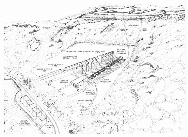
Fig. 5. — Vue perspective schématique des ouvrages souterrains.
