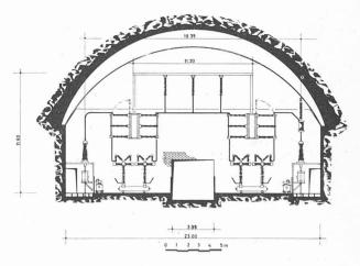
Fig. 7. — Coupe en travers du poste de couplage.
