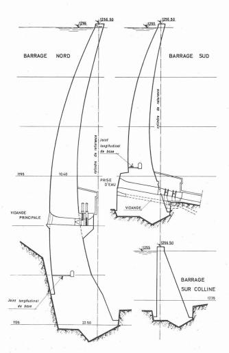
Fig. 5. — Coupes en travers des barrages.
