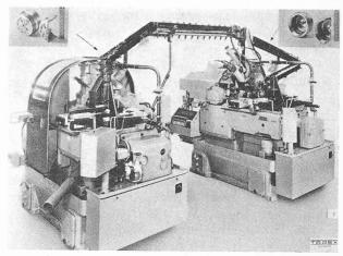
Fig. 4. — Tours automatiques Tarex, alimentation et transfert automatiques.
