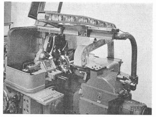
Fig. 3. — Tour automatique Tarex avec alimentation automatique.
