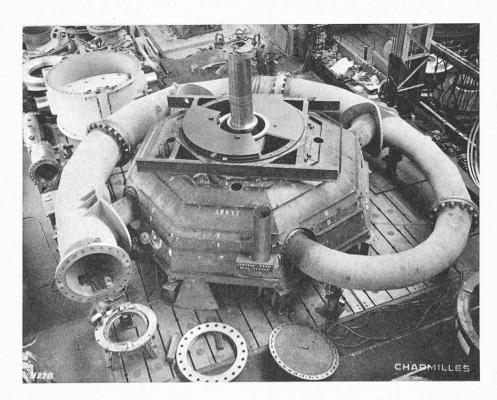
Fig. 2. — Montage en usine d'une turbine Pelton 4 jets pour la Centrale de Cubatão. Puissance 88 000 ch; chute 684 m.
