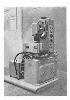
Fig. 1. — Machine d'usinage par électroérosion.
