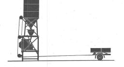
Position de transport. Silo à ciment sur le pont du camion avec balance montée. Support métallique avec bétonnière en remorque.
