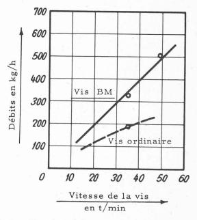
Fig. 5. — Extrudeuse BM 150, 15 D.
