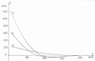
Fig. 5. — Déformée d'un tube en acier.
