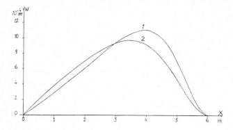
Fig. 1. — Déformée d'un réservoir cylindrique en béton.
