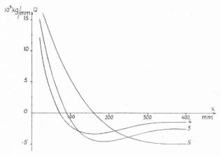
Fig. 8. — Répartition de l'effort tranchant pour un tube en acier.
