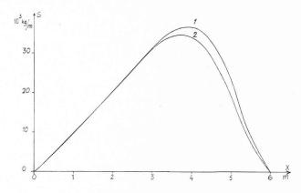
Fig. 2. — Répartition de l'effort annulaire pour un réservoir cylindrique en béton.
