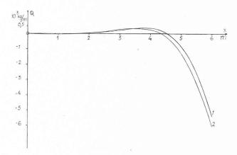
Fig. 4. — Répartition de l'effort tranchant pour un réservoir cylindrique en béton.
