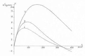
Fig. 7. — Répartition du moment fléchissant pour un tube en acier.
