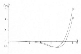
Fig. 3. - Répartition du moment fléchissant pour un réservoir cylindrique en béton.
