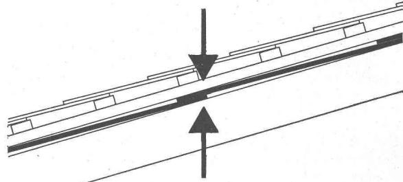
Le maître couvreur recommande la soustoiture ETERNIT, élément nécessaire du toit. Les plaques d'amiante-ciment ETERNIT et GEA en augmentent le pouvoir isolant. Elles forment une couverture étanche aux poussières, à la pluie, à la neige et à l'eau de fonte de celle-ci. Incombustibles, elles diminuent le danger d'incendie. La pose de la soustoiture ETERNIT est simple et rapide.
