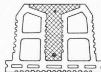
Coupe de la poutrelle préfabriquée : béton pervibré, coffré par la terre cuite, nervure en T rationnelle ; isolation parfaite.
