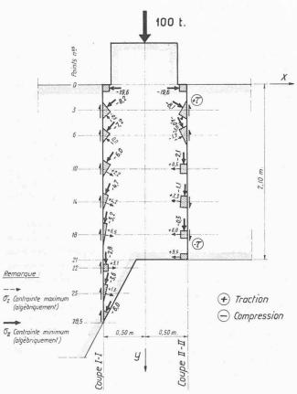
Fig. 16. — Cas de charge P2. Contraintes principales sur l'ouvrage en kg/cm². Coupes I — I et II — II.
