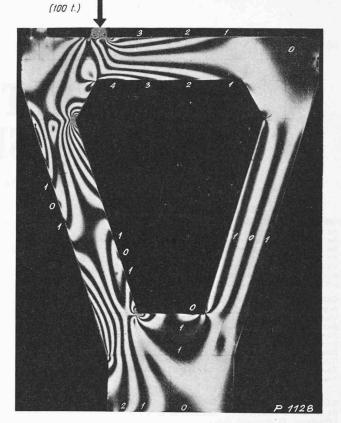
Fig. 11. — Cas de charge P2: réaction sur appui intérieur. Lignes isochromes  $(\sigma \overline{1} - \sigma \Pi) = \text{const.}$  Contraintes sur l'ouvrage:  $\sigma \log/\text{cm}^2 = 2,38.m$  m = ordre des lignes isochromes.
