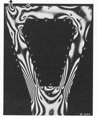
Fig. 9. — Cas de charge P1: réaction sur appui extérieur. Lignes isochromes  $(\sigma_{\rm I} - \sigma_{\rm II}) = {\rm const.}$  Contraintes sur l'ouvrage:  $\sigma \, {\rm kg/cm^2} = 2{,}38.m$   $m = {\rm ordre}$  des lignes isochromes.
