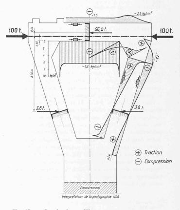
Fig. 17. — Cas de charge X2. Contraintes parallèles aux bords en kg/cm² (contraintes principales).
