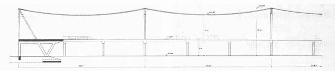
Fig. 4. — Toiture suspendue, coupe longitudinale.
