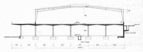
Fig. 8. — Projet exécuté, coupe transversale sur un pavillon.
