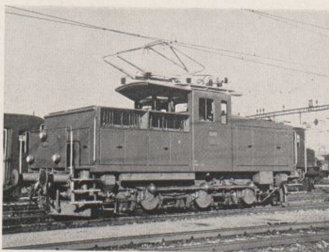
Fig. 20. — Une locomotive de manœuvre « quadri-courant » des CFF, pouvant être alimentée, au choix, en courant monophasé 25 kV 50 Hz, ou 15 kV 16\frac{2}{3} Hz, en courant continu 1500 V, ou 3000 V. Il a été possible, malgré la complexité de l'équipement électrique et les faibles dimensions de ce genre de véhicule, de construire un engin prévu pour la pleine puissance, quel que soit le système utilisé
