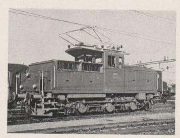
Fig. 20. — Une locomotive de manœuvre « quadri-courant » des CFF, pouvant être alimentée, au choix, en courant monophasé 25 kV 50 Hz, ou 15 kV 16 2/3 Hz, en courant continu 1500 V, ou 3000 V. Il a été possible, malgré la complexité de l'équipement électrique et les faibles dimensions de ce genre de véhicule, de construire un engin prévu pour la pleine puissance, quel que soit le système utilisé
